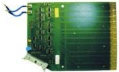
機型: MULLER III 名稱: 龍頭電磁鐵電子板 備注: 191,5/1,6X231,2 國外編號: 179 729 218
